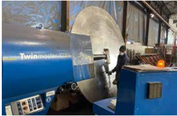
La Twinmaster 12X de Pedax est une cadreuse compacte, polyvalente, performante et peu bruyante.
